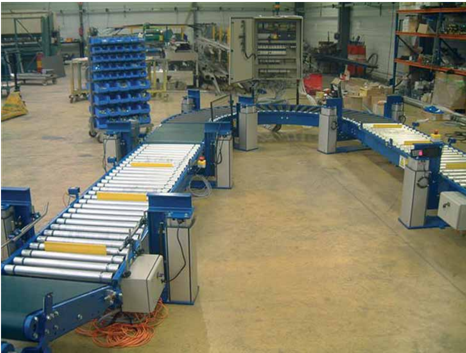
Abb. 5: Ergonomisch höhenverstellbare Förderstrecke für die Verpackung von Druckern
