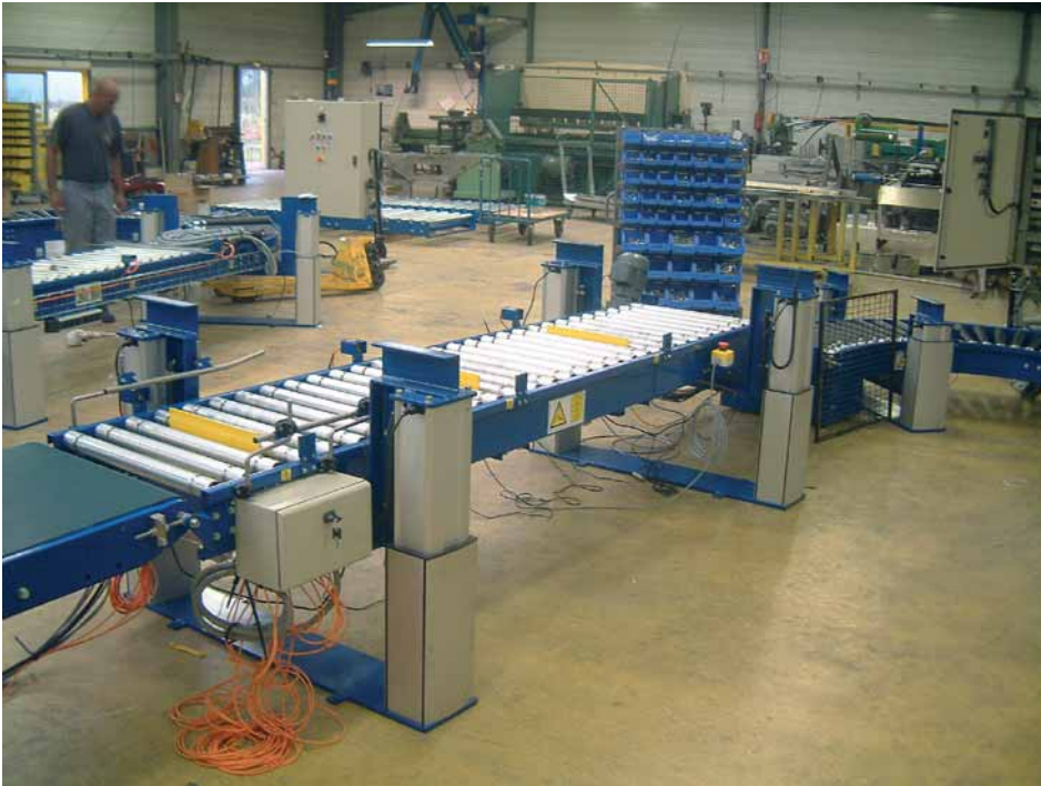
Abb. 2: Ergonomisch höhenverstellbare Förderstrecke für die Verpackung von Druckern
