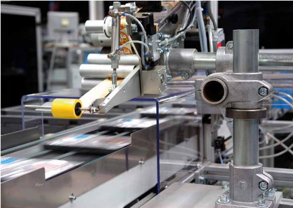
Abb. 3: Etikettierkopf mit stabiler Halterung aus Rohrverbindungselementen
