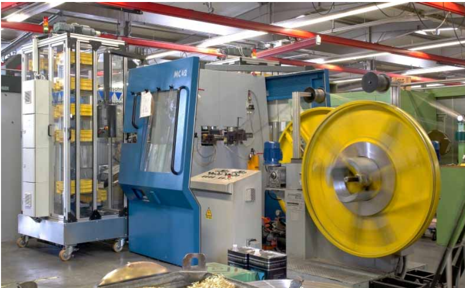
Abb. 1: Automatische Produktion mit anpassungsfähigem KLT-Magazin
