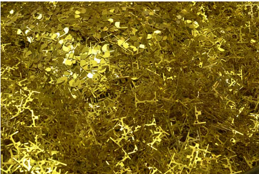
Abb. 3: Ständig in Vibration. So kann sich kein Schüttwinkel bilden. Das Fassungsvermögen wird optimal genutzt.
