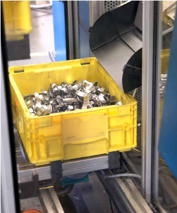
Abb. 3: Ständig in Vibration. So kann sich kein Schüttwinkel bilden. Das Fassungsvermögen wird optimal genutzt.
